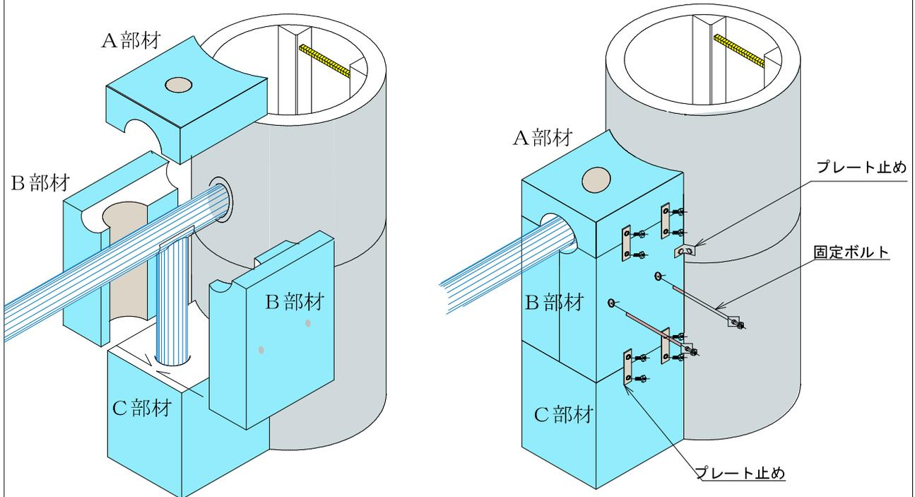
\*A部材を使用しないでB部材を管底から300mm下げた所で製作する事も出来ます。
